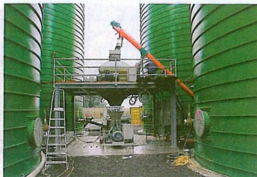
In den Ligatoren-Silos wird der pumpfähige Körnermaisbrei konserviert. Bild Mitte, Schrottmühle mit Anteigapparat
