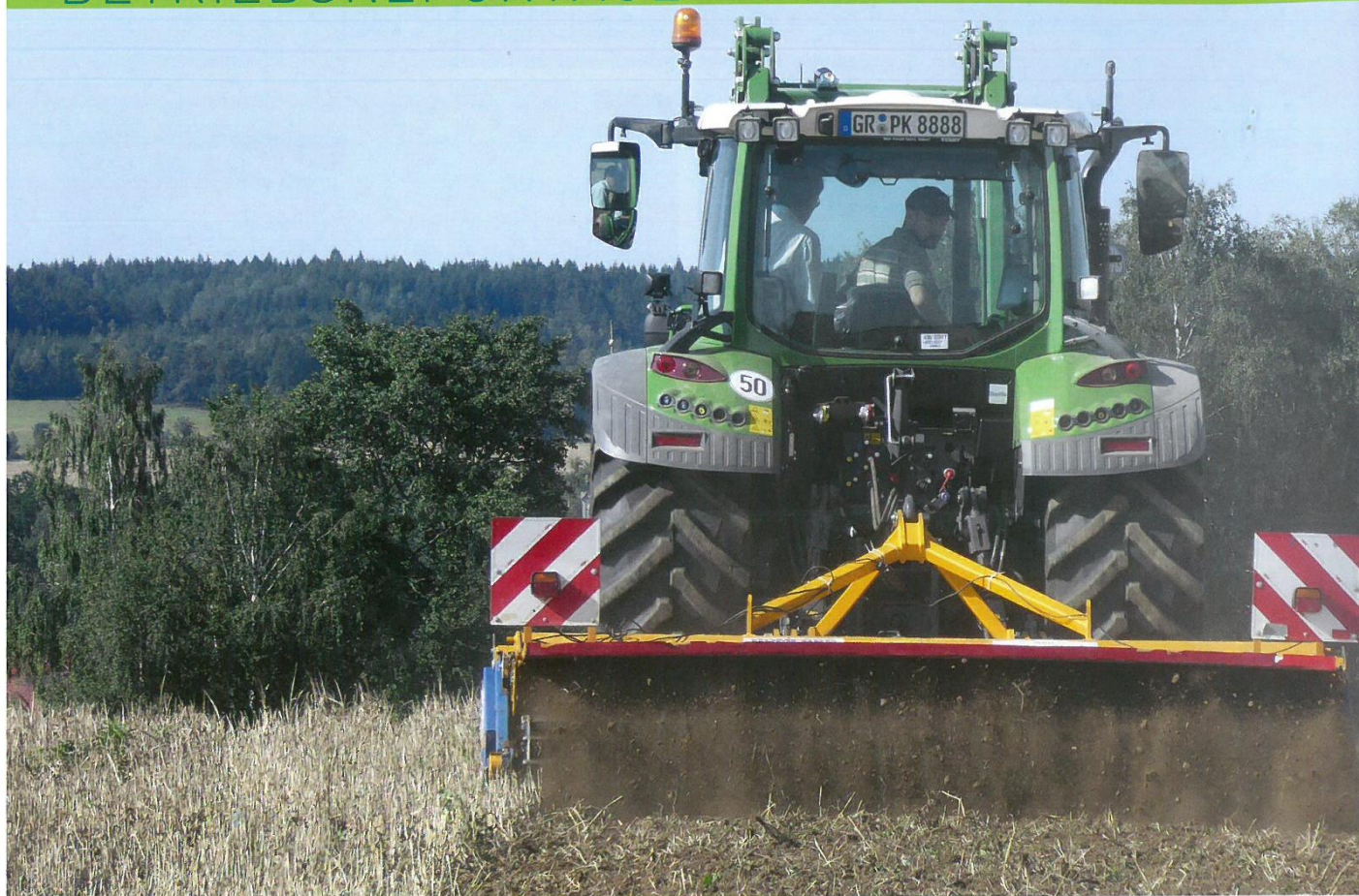
Zinckenrotor Dyna Drive PRo 3 beim Stoppelumbruch: Die Unkräuter werden vollständig abgeschnitten.
