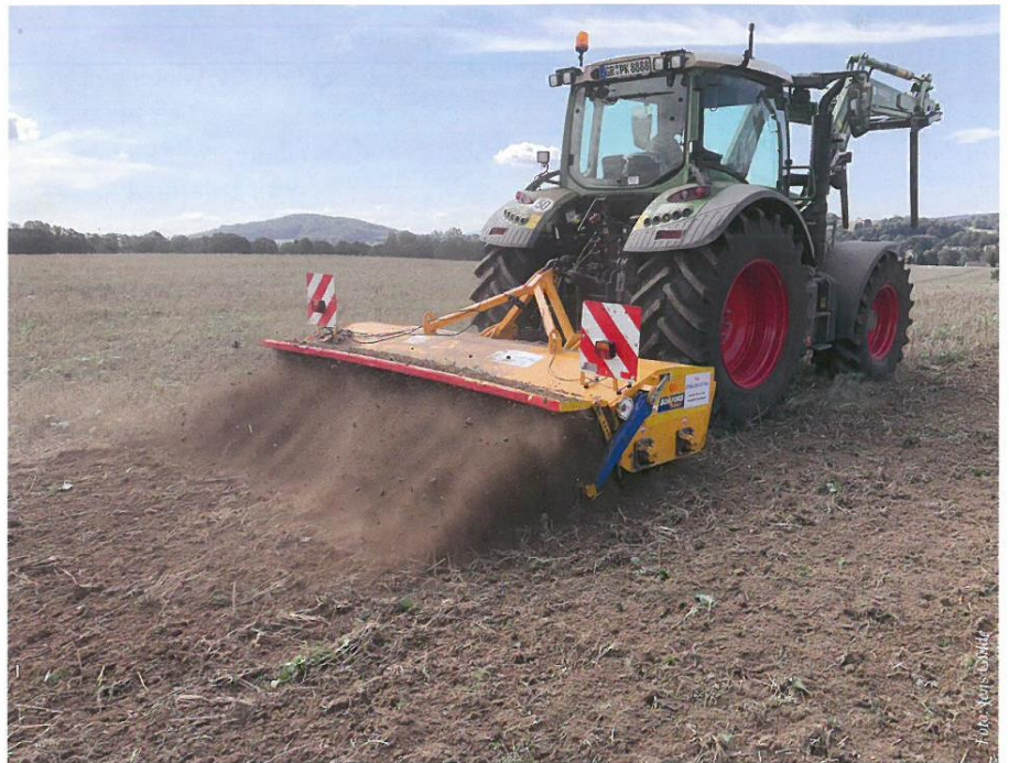
Im Gegensatz zum Grubber lässt der Zinkenrotor Dyna Drive Pro 3 die Steine im Boden.
